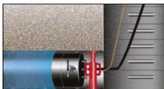
La pose d'un étai dans la canalisation sera nécessaire lors de risque de forte contre-pression supérieure à celle acceptée par l'obturateur.
